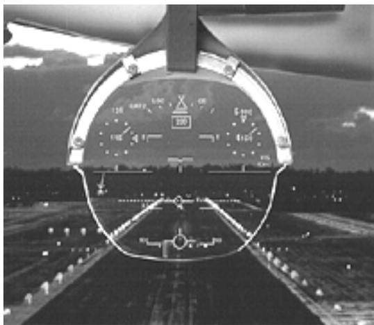
Рис.6.10. Индикация системы HGS на посадке
